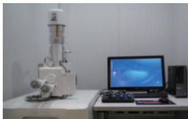
エネルギー型X線分析装置付属走査型電子顕微鏡装置
